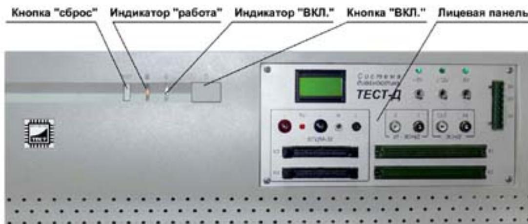
Рис. 2. Передняя панель блока диагностики БД-03CU
